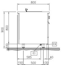
Electrical inlet (power) Equipotential screw
